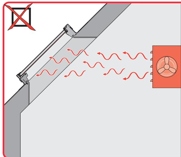
×3) エアコンの空気を直接ガラスに当てないでください。ガラスに温度差が生じて、熱割れが発生する場合があります。天窗から離れた場所に設置してください。
