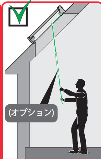
!1) 棒操作でブラインドを遠隔操作する際は脚立等を使って操作せず、床に立って行ってください。長さが足りない場合は延長棒(オプション)を接続し操作してください。
